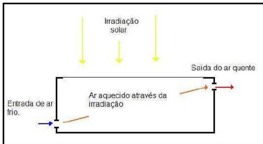
Figura 1: Esquema de secagem através da energia solar.
