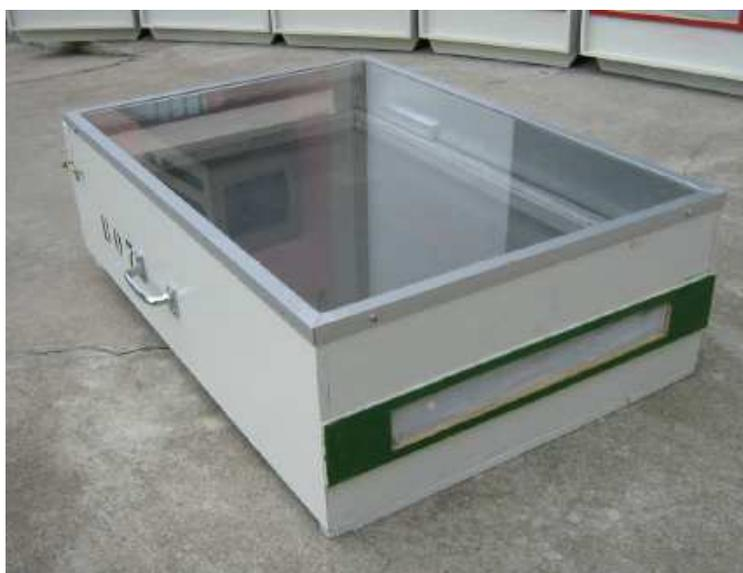
Figura 2: Secador com cobertura de vidro.
