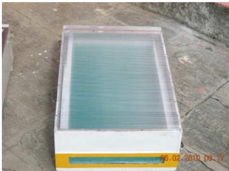
Figura 3: Secador com cobertura de policarbonato.
