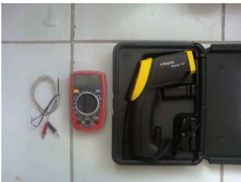
Figura 4: Equipamentos para medição de temperatura.
